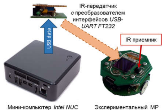
Рис. 7 – Структурная схема экспериментального стенда
