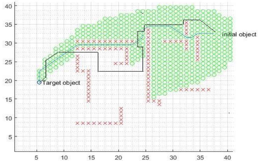
Рисунок 5.9 – Диаграмма пути для предложенного и классического алгоритма планирования траектории (динамический алгоритм A^* ) для сцен сложной топологией
