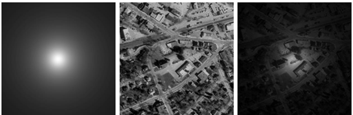
Рисунок 6.7 – Восстановление изображений от МНП на примере неравномерного освещения сцены для диапазона [0.1, 1] : а) вид функции освещенности для диапазона [0.1, 1] , б) исходное изображение сцены, в) изображение, которое было искажено МНП и белым шумом (значение отклонения равно 1)
