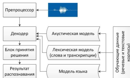
Рисунок 1 – Схема работы программных средств распознавания речи
