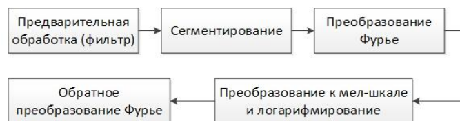
Рисунок 2 – Процесс вычисления параметра MFCC
