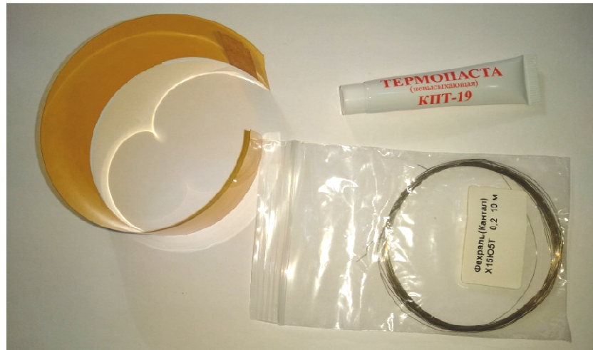
Рисунок 4.2 – Исходные материалы для формирования обмоток нагревателей
