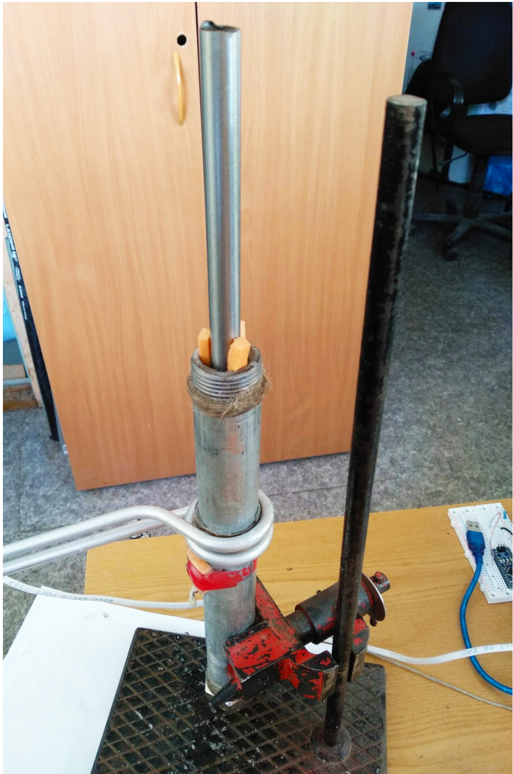
Рисунок 4.47 – Приспособление для заливки парафина в преобразователь
