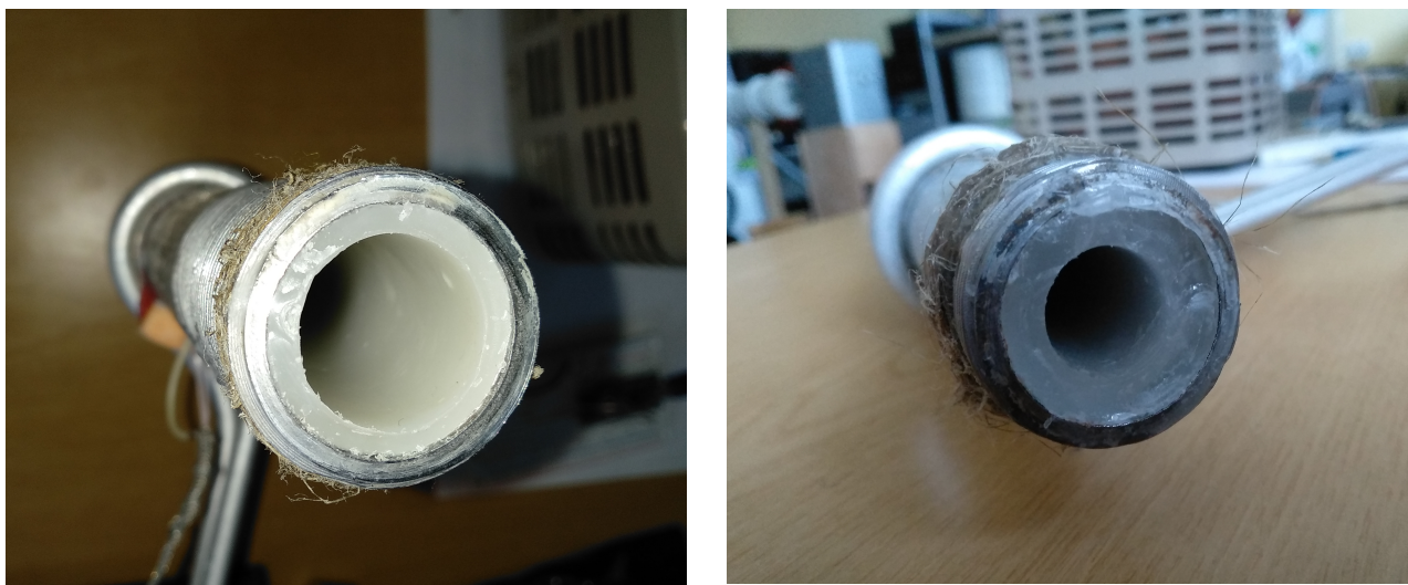
Рисунок 4.48 – Примеры сформированных слоев парафина калиброванной толщины
