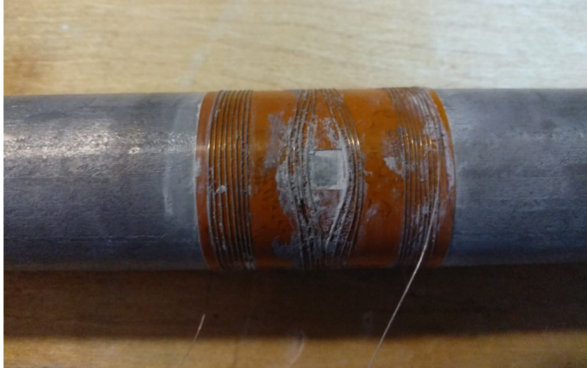
Рисунок 4.5 – Вокруг места установки датчика обмотки раздвинуты
