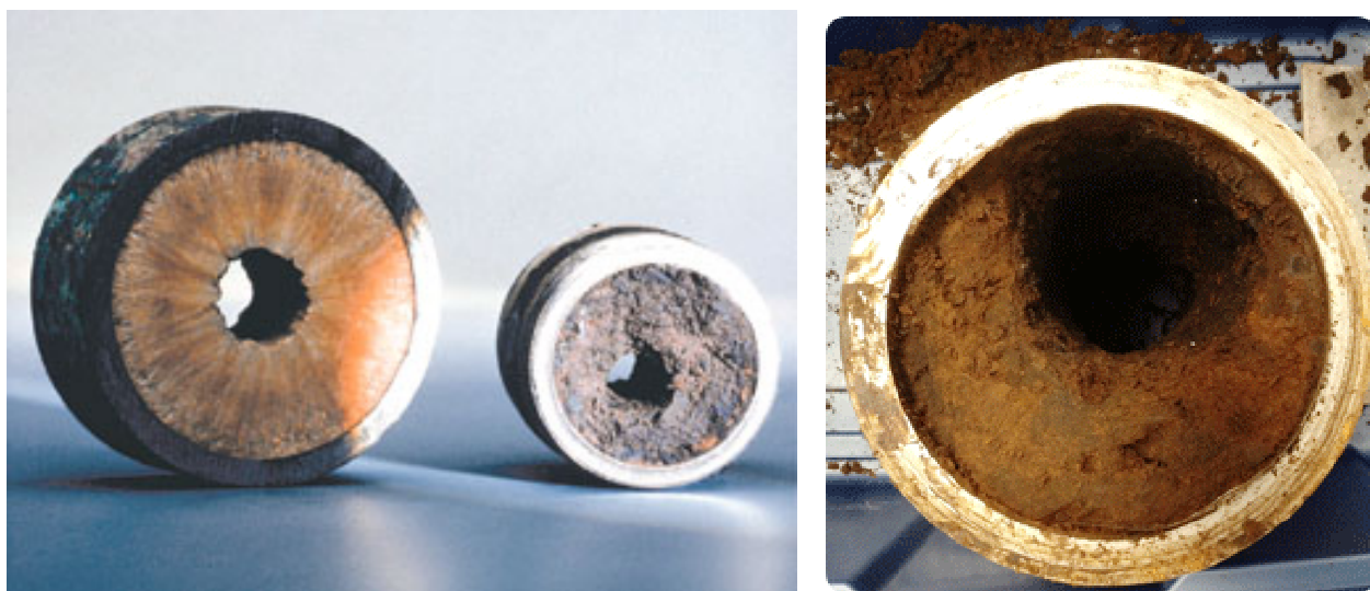
Рисунок 1.1 - Образцы срезов нефтепроводов с АСПО
