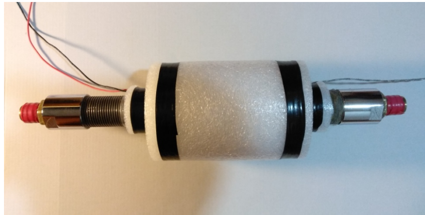
Рисунок 4.12 – Окончательная термоизоляция трубы несколькими слоями пенополиуретана
