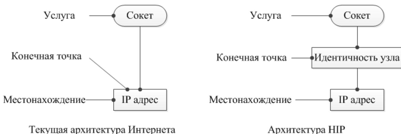
Рисунок 1.7 – Различия между связями логических объектов текущей архитектуры Интернета и NIP архитектуры
