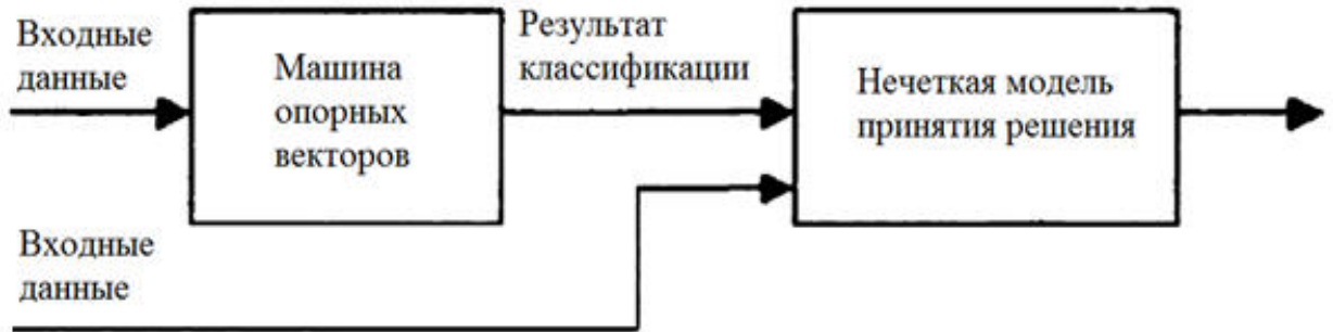
Рисунок 3 – Схема метода обнаружения вредоносных программ
